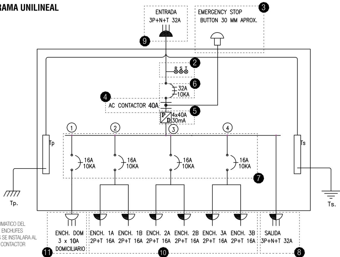
NOTA: EL AUTOMATICO DEL CIRCUITO 1 DE ENCHUFES DOMICILIARIOS SE INSTALARA AL COSTADO DEL CONTACTOR
